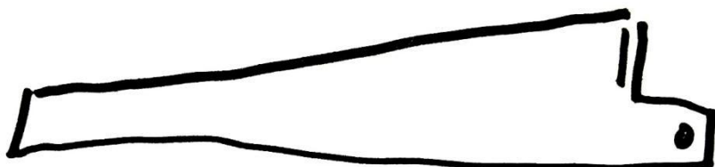
FAN BLADE FROM PVC PIPE
